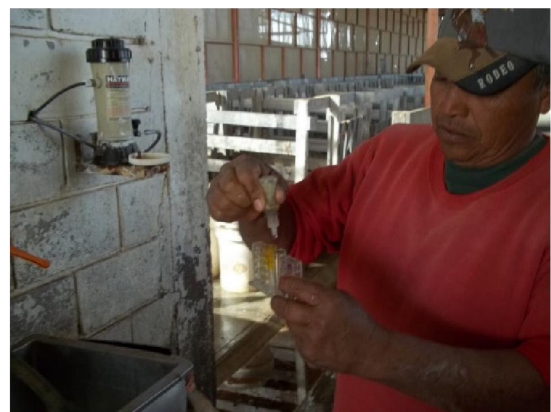
4. Calibración (ppm de cloro)
